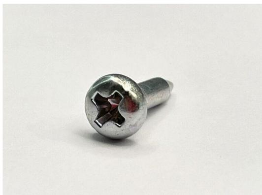
本製品は先端とがり先部を転造で成形を行っているため大量生産を可能にしています。また、軸部根元にネジ部があるためとがり先箇所をねじ転造でつぶさないような金型を作成しております。
