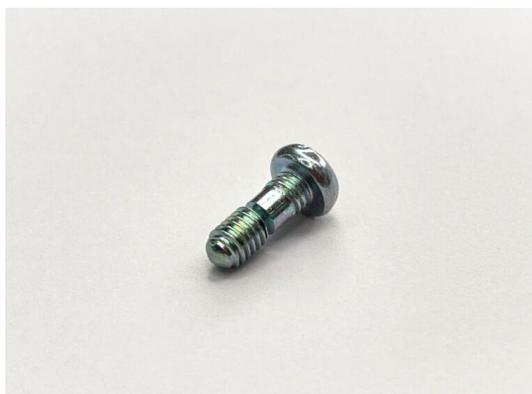
圧造→転造にて通常の十字穴付ナベ頭ネジを作成したのち、軸溝部を切削でφ1まで削っています。こちらの製品が取り付けられる使用箇所を開けることができないようにするために、一定数の力がかかることで折れるように設計されています。そのため、当社でトルク管理まで行った製品になっております。
