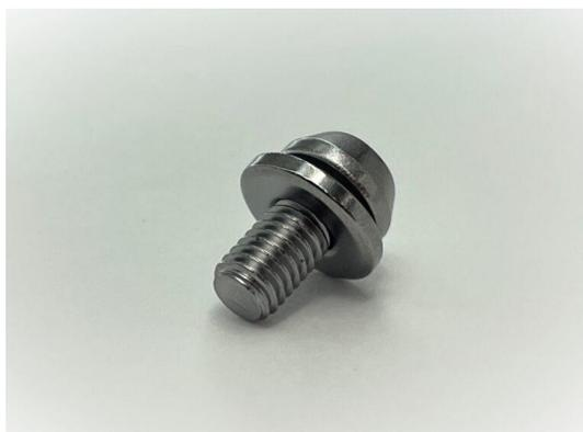
単純なセムスボルトに見えますが、六角穴をツバ厚み近くまで深く打ち込んでおり、頭部形状を丸形状に維持できていることが特徴です。また、座金には特殊鋼を使用しているため、座金組込み転造後の熱処理も可能です。表面処理はスズコバルトメッキのため、外観もキレイに仕上がっています。
