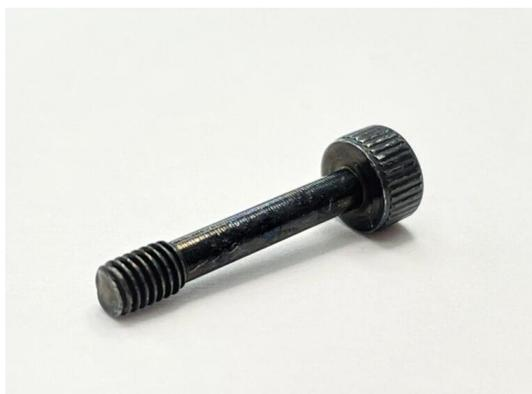
脱落防止ねじの機能として、製品と相手材を締結した際に、ネジ部より軸部が細くなっているために、相手材がネジ部で止まるようになっています。こうすることで、相手材から製品を取り外した際にも、ねじが外れることがなくなります。
