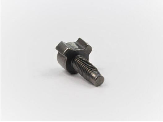
切削加工で行っていたものを圧造で出来ないかという要望により、当社から圧造+二次切削+プレス成形での工法転換をご提案いたしました。また、バリの除去+製品外観を滑らかにすることを目的として、成形・切削後にバレル研磨を行い、最後にねじ転造をしています。
