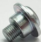
シートベルト向けの製品のため、組付けレイアウトが狭く、非常にネジ部の短い製品となっております。ネジ部が短寸である中で、不完全ネジ部が1ピッチ以下というお客様からのご要望もあり、非常に難易度の高い製品でした。しかし当社の水平式転造機を使用することで、量産に成功した製品です。
