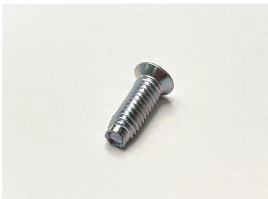
加工ポイントとしては、タッピングネジの特性である雌ネジを形成しながら、埋め込まれていくために必要な硬さを浸炭処理によって出している点があげられます。また、自動車関係ということもあり、表面処理でのベーキングを行うことで水素除去にもこだわり、リスク低減にも貢献いたしました。
