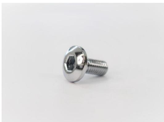
圧造ブランクにて作ったツバを切削にてツバがなくなるまで削っております。また外観に重きを置かれるお客様のご要望にあわせて、切削加工の後にバレル研磨を行うことでバリを除去しております。その後転造を行い、表面処理の中でも特に銀白色の強いクロームメッキを採用している外観重視の部品です。
