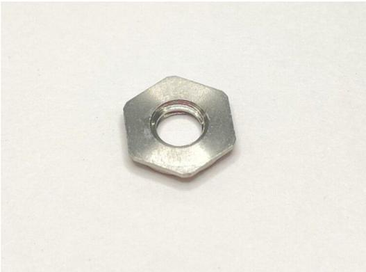
本製品はバーリング加工での無理曲げによる母材の膨らみを嫌う製品（外観部品）にオススメな製品です。本製品の特徴とは、板金に対して完全に埋め込まれる構造となっているため、表面をフラットに仕上げたい場合に使用されるクリンチングナットとなっております。
