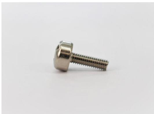
つまみネジは、最終消費者でも締め外しができるように設計されたネジです。そのため、プラス・マイナスのどちらのドライバーでも作業できるように、プラスマイナス形状が採用されることが多くなっています。この形状は、当社では特殊パンチを使用して圧造加工しております。
