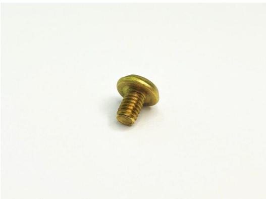
真鍮で作られており、軸が短いことが特徴です。軸が短いため、ネジ部の成形が難しくなっています。しかし当社では、軸が短いネジへの転造加工も得意としております。またお客様からの要望により、不完全ねじ部を極力短くしてほしいとのことでした。そのため当社では、不完全ねじ部をほぼ無しで成形いたしました。
