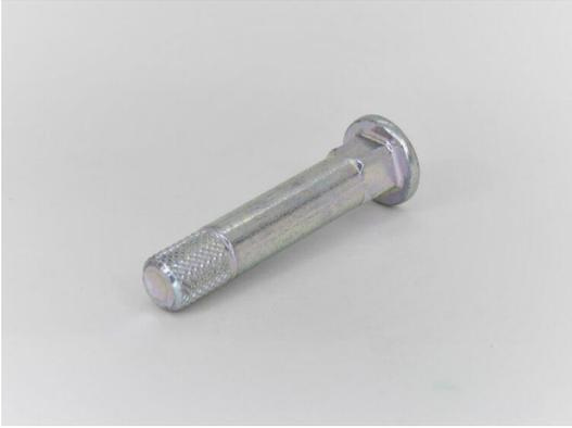
ツバ下を五角形に圧造成形し回り止め機能を実現いたしました。また、転造によりアヤメローレットを付けることで、相手部品と嵌合した際の摩擦係数を向上させ、外れ防止機能も付与しております。さらに、その用途ゆえに強度も必要だったため、SCM435材を採用&熱処理により硬度を上げております。
