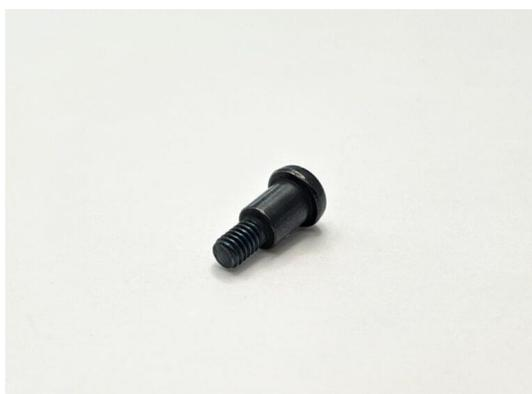
加工ポイントとしては、不完全ねじ部が短いこと、十字穴が深いこと、追加工としてボンドを塗布し緩み止め加工を施している点が挙げられます。径も細いこともありましたが軸部がそれ以上に長いのでネジを成型する際のダイスへのくい付きタイミングが難しい製品です。
