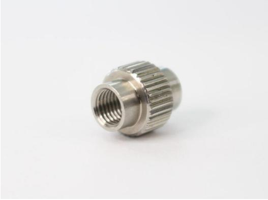
こちらの製品は、全切削にて製造しております。製品の特徴としては、製品中ツバ部にあるローレット加工です。樹脂にホールドされる予定の製品のため、ねじを締結した際に緩まないようにローレット加工をしています。
