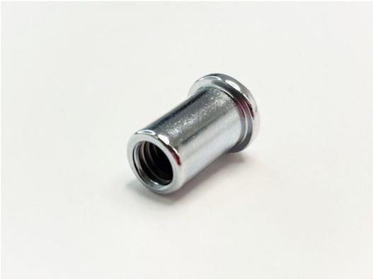
ツバ側に六角穴が空いておりレンチで締めて行き、ツバが車体と当たって固定する仕組みです。このナットが外れると部品が脱落して非常に危険であるために非常に重要な役割を持ったナットです。そのために非常に高強度で、六角穴も深く、レンチできつく締めても六角穴もネジもつぶれない商品になっています。
