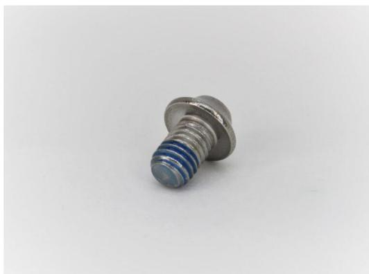
圧造工程の六角穴深さと、頭部の滑らかなR形状、緩み止め機能の3つが特徴です。材質もSUS XM7という加工性の良い材料ではありませんが、この手の形状は大量生産を得意としております。
