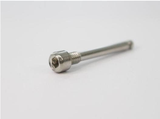
座面側にねじ部があり、その下に軸部があります。写真でもご覧いただけますが、軸部には溝入れを行っております。こちらのリベットは頭部が大きく、六角穴も深く、軸部が細いというアンバランスな形状です。そのため、圧造加工と転造加工ともに、非常にバランスが取り辛く、加工難易度が高い製品でした。
