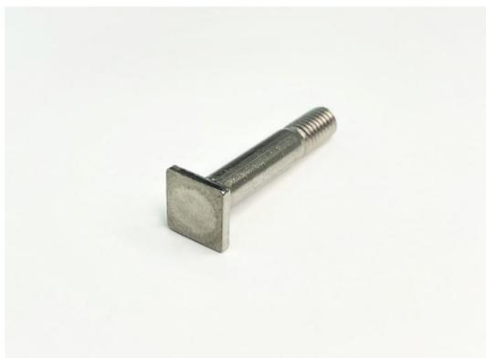
四角形状については、頭部を圧造で丸く打った後にトリミングにて四角形状に加工しています。軸の形状については、首下ローレットを施した後にねじを切っています。ローレットは、首下すぐの箇所に施しています。ねじを切る際に不安定になることがありますが、弊社の転造技術によってそれをカバーした製品です。
