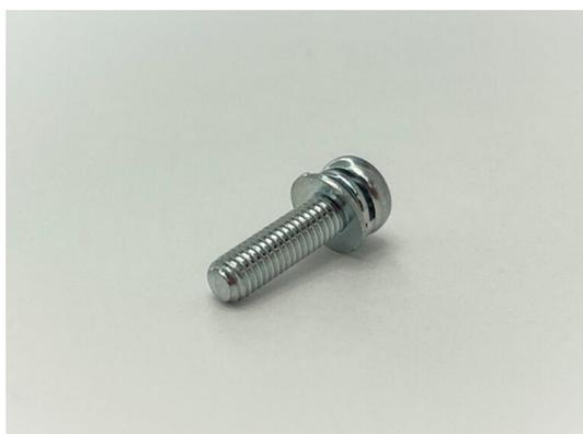
こちらの商品の特徴としては、ワッシャーが2枚組み込まれている箇所になります。1枚は平ワッシャーで、座面との設置幅を大きくする意図があります。もう1枚はスプリングワッシャーで、反発する力を利用し、緩み止め効果を発揮します。そのためワッシャーが1枚のセムスねじと比較して緩みにくくなっています。
