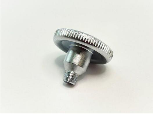
こちらは工作用ののこぎり歯を固定する目的のネジです。歯を交換する際に、外周のローレットを手で回して緩めて歯を交換します。本製品はネジ自体が外観に出る部品であり、天面の凹み部はヘッダー時の切断痕が残っているため、ショットブラストで綺麗に仕上げています。
