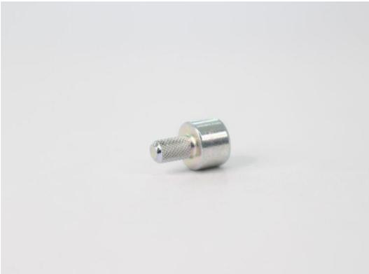
頭の大きさに対して軸が細い製品になっております。また、こちらの商品は樹脂にインサートされるため軸部にアヤメローレット加工を施しており、相手材とのかみ合わせを良くしています。平目ローレットではなくアヤメローレットにすることで樹脂との設置面積が増え噛み込みやすく外れにくいという性質があります。
