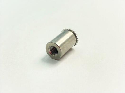
一般的には全切削にて製作される製品のため、量産時でのコストダウンが期待できない部品でした。しかし、なんとか工法転換をしてコストダウンできないかとのことで、当社にご相談をいただきました。そこで当社からは、全切削から圧造＋二次加工による工法転換での加工方法をご提案いたしました。
