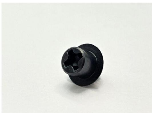
本製品の特長は、首下不完全ねじ部が短い点です。こちらの製品はネジ部が極端に短いため、もみ切り転造にて加工することで安定した良品供給が可能になっております。表面処理においても外観・製品寸法・耐食性を損ねないSSブラックを採用しています。
