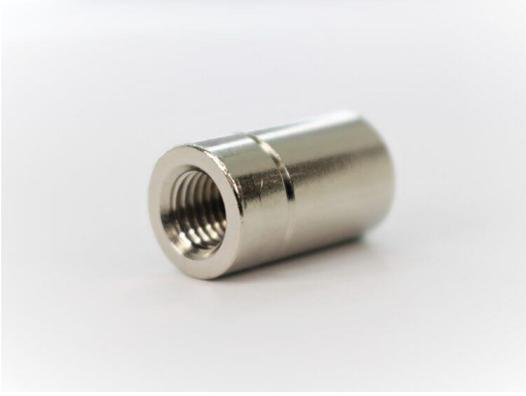
まず多段圧造により圧造ブランクを成形し、雌ネジタップ後に切削にて外周に溝入れ加工をしております。
