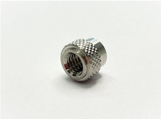
全切削で形状全体を製造し、転造でアヤメローレットを付けている製品です。ナットとしての機能を果たすことはもちろんのこと、ローレット加工を施すことで、樹脂との食いつきがよくなり、ボルトで締結した際に樹脂の中で空回りしないよう製造しています。
