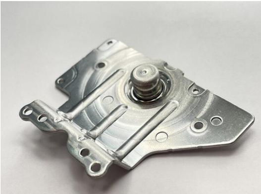
素材の板厚1.0mmに対して、最大1.7倍の増肉成形を実現しております。こちらは自動車の軽量化のためにダイキャストで製作していましたが、プレス加工に工法転換することでコストを1/3以下に抑えることに成功しました。さらに外観性の要望に応えるため、傷・汚れを取り除いております。
