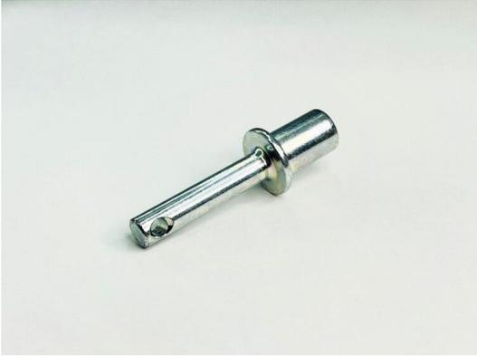
本製品の特長は、軸部に空いた穴です。軸部に穴が空いていることでそこにケーブルなどを通すことが可能になります。その為、本来2部品で締結していた箇所を1製品にすることを可能にしました。また、精度としましては頭部を基準にして同軸度（0.01）を設けられており、同軸度においても精度を追求しています。
