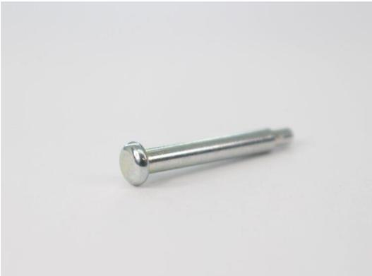
お客様組立て時のご要望で、サブAssy工程で複数の部品を仮止めしたいとのことでした。そのため、先端細軸部分に3箇所のリブ出しをした製品になります。3箇所のリブは圧造にて成形しておりますので、同工程で形状を出せているため加工単価においてもお客様の満足を得られました。
