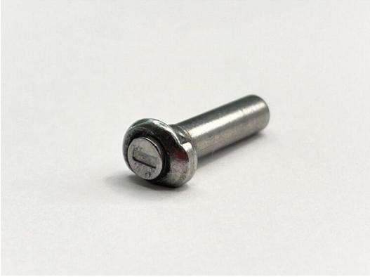
写真でもお分かりいただけるかと思いますが、非常に特殊な異形頭部形状となっております。また、先端C面は転造によるもみ付けとしております。自動車用シートベルトの巻取装置に組付けられており、プリテンショナ機構の部分で使用されています。
