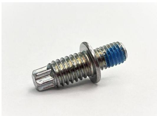
まず中ツバにより2製品が連結できるようになり、片側は緩むことによるリスクケアのためナイロック加工を施しています。また表面処理にジンロイを使用することで耐熱性を強化し、さらに三価クロメートをつけることで耐食性も併せ持った製品となっております。
