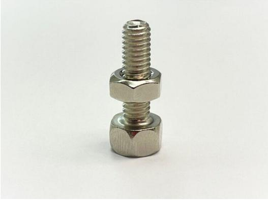
写真の通り、ナットASSYまで当社で対応しております。圧造後に、六角頭形状の天面にNC旋盤で逆テーパの袋穴加工をしています。この袋穴の公差レンジが0.04と非常に精度面で厳しくなっておりました。当社では、次工程のメッキ膜厚も考慮した上で、公差設定をして量産製造まで対応しております。
