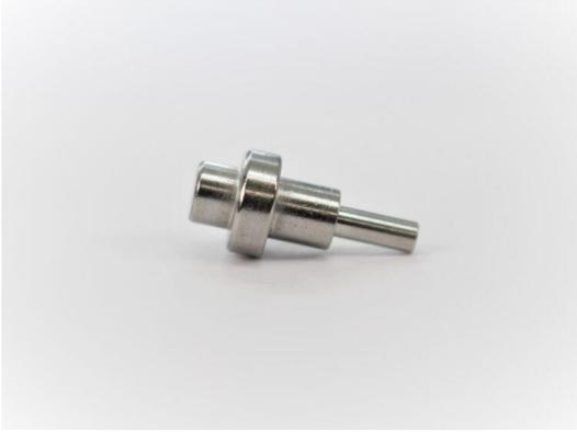
材質はSUS X M-7系のため、細軸を絞り可能な部分まで金型で成形し、二次加工切削で仕上げております。切削図面からの形状、公差もほぼ変更せずにニアネットシェイプが出来た製品です。結果として全切削からの工法転換でコストダウンを実現することができました。
