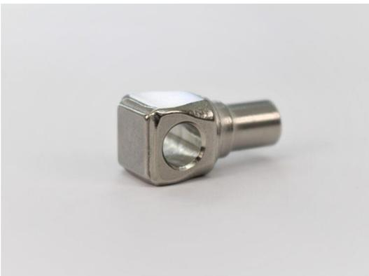
お客様からご相談いただいた際にお伺いしたところ、以前は角材から全切削で製作されていたとのことでした。当社では、小型化と軽量化を実現するために、圧造加工によるニアネットシェイプ化をご提案しました。横穴はMCにより専用治具を用いて複数個を同時加工しているため、生産キャパにも自信のある製品です。
