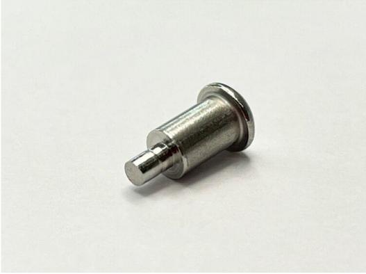
加工ポイントとして、軸部切削の際に、Rを除去しています。またこちらのピンはステンレス製のピンのため、パシベート加工にて耐食性を向上させています。
