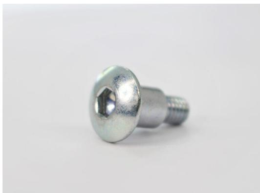
こちらの製品ポイントは、2段目の角をいかにピン角にできるのか、という点でした。ピン角でなければいけない理由としては、圧造でのダレによって締結した後のぐらつきを気にされるとのことでした。その為、金型設計時にダイス内での素材の動きをコントロールできるように緻密に設計しました。
