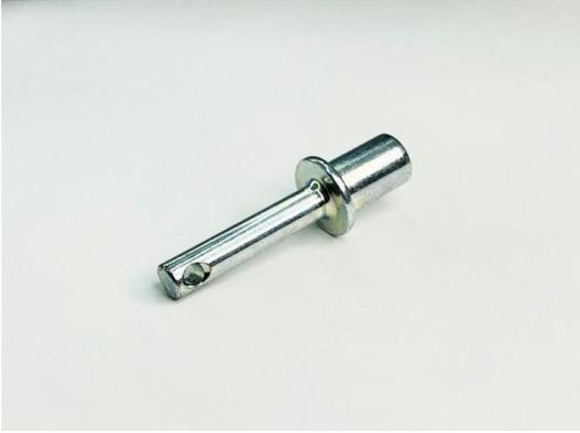
この製品は、軸部と頭部の径に大きなギャップがあるため、圧造ブランク成形時に金型製作に苦勞しました。また、軸部にある穴は切削によって開けられています。軸部の穴には同心度が求められるため、穴あけ時に軸がぶれないようにチャッキングする必要があります。
