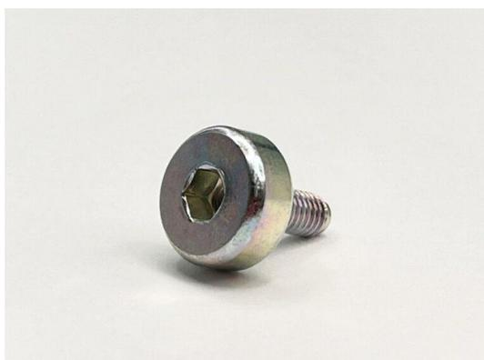
一般的な規格ねじに見えますが、軸径が頭部径に比べて細いため圧造での断面減少率が厳しくなっています。本製品を二次切削をいれずに圧造で量産するために金型作成から取り組みました。その際に断面減少率の観点から難しい商品ではありましたが、当社の設計技術により量産できた商品となります。
