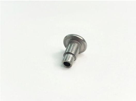
本製品は、SUS430で製造しています。形状としては、段付きピンで軸部端面からφ2.5mm、深さ3mm程の穴が空いており、ヘッダー加工での穴あけを行うことで切削レスとなり、トータルコストダウンを実現しました。
