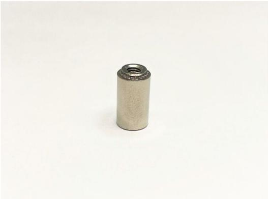
本製品は、板金の直上に基盤をマウントする際の正確な高さ出しとして使用されます。板金に対して、高さだしを行いたい方向の上から圧入するだけで締結可能となりますので、取付が容易です。また製品を作成するにあたり、軸部段に抜け止め加工が施されていることもあり、切削加工での精度が求められます。
