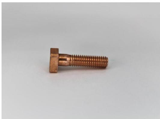
頭部の四角形状については、圧造設備内で丸形状から四角形状にトリミングをしている製品です。通常2ダイ3ブローヘッダーの場合は、別工程でトリミングをすることがほとんどです。しかし当社では圧造工程内でトリミングをするため、コスト的にも大きなメリットを生み出すことができます。
