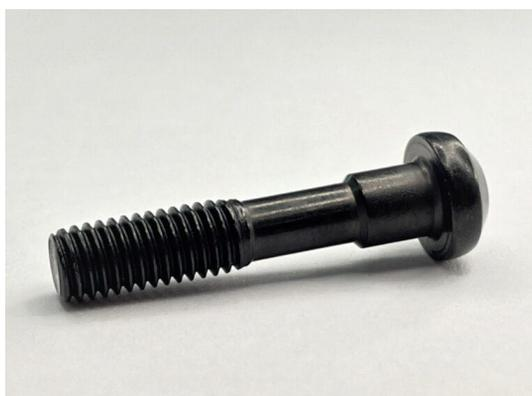
圧造にてブランクを製造した後に、切削→転造→熱処理→表面処理という、当社が得意なパターンの加工工程にて製造いたしました。また、こちらの製品は表面処理に特にこだわりをお持ちのお客様のご要望により、ハイニッケルの後にパーキング+コート付けを行うことで、高級感のある光沢に仕上がっています。
