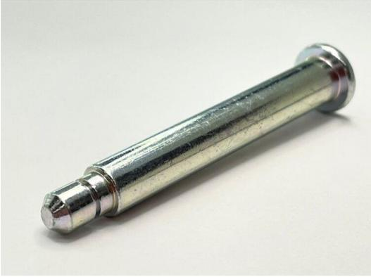
切削加工を施している部分が短く、軸部が長いこともあり、転造での溝入れ加工が難しくなっています。そのため今回は、切削での溝入れ加工にてご提案いたしました。
