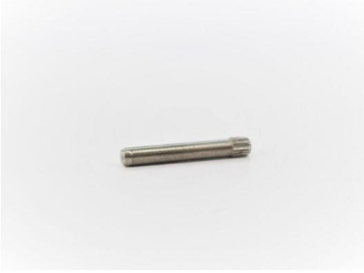
転造工程で平目ローレットを入れた後に、ツバをもみ切るフォームローリングを採用することで、二次切削をすることなく量産に対応・コスト面での評価も高い製品となっております。
