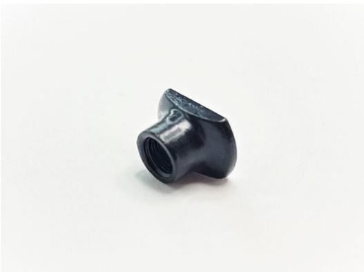
制動機の相手部品の中に入っているナットです。位置決め・回り止めのためにツバ部が大きい小判形状になっております。また高い締付力・制動の摩擦による高温・悪路走行による高振動でもつぶれず耐えうるほどの高強度を持ったナットです。
