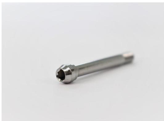
頭部形状と左ねじの2点がポイントです。頭部形状へのこだわりから、切削加工にて頭部を加工しておりますが、25度の角度で削ることで、膨らみを持たせ丸みを帯びた頭部となっております。また左ネジという点に関しては、右ネジを使用していたら緩んでしまう箇所に用いることで、緩まないようにするネジです。
