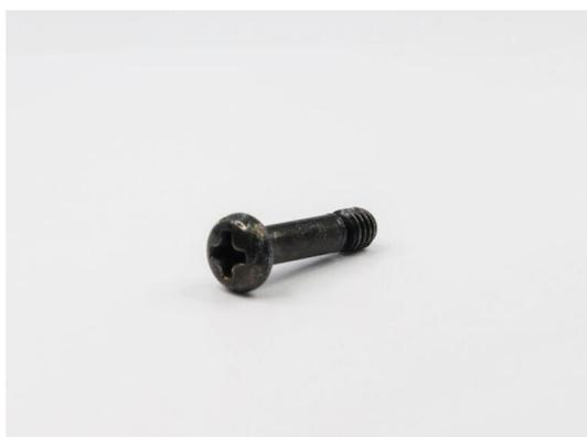
こちらの製品のポイントは、軸部にある溝入れ加工です。こちらの製品が相手製品に挿入されていく中でトルクがかかった際に溝入れ箇所を折れることで、ネジ部のみがはまった状態で残ります。その結果、半恒久的な緩み止めとしての機能を発揮します。
