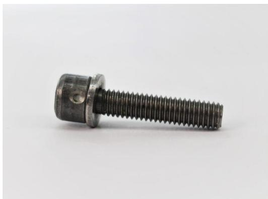
この製品の特徴は、頭部の貫通穴の径が小さい点です。貫通穴が小さくなると、穴あけに使用するドリルが折れたり、ドリルが摩耗して振れが大きくなって安定した穴加工ができなくなります。こうした点から切削の難易度が高い製品です。
