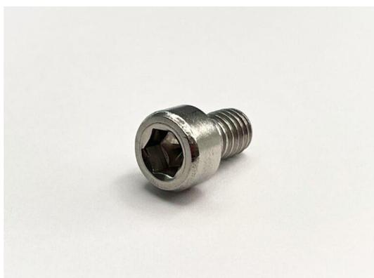
圧造にて六角穴の深さを座面近くまで打ち込んでいます。そのため、パンチを打ち込んだ際に引っ付きが生じるため、加工難易度としては高くなります。また、屋外での使用・屋外での保管を鑑みて、ステンレス専用の防錆処理を施しています。
