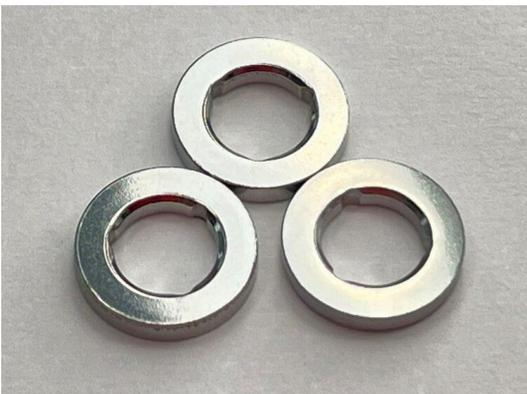
こちらは従来は切削加工で製作していたものをプレス加工に工法転換した製品です。材料費や加工時間がプレス加工では解消され、安定した品質をコストダウンして納品することが可能となります。さらに金属の靱性に影響を与えるファイバーフローを活かしたまま加工が出来るので、強度が大きく向上します。
