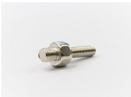
中ツバ六角形状に対し、上下に異なるネジサイズとなっています。そのため、ねじ転造をする際の供給が難しく、さらにお客様のご要望により不完全ネジ部も少なく、当社の転造技術を駆使した製品です。
