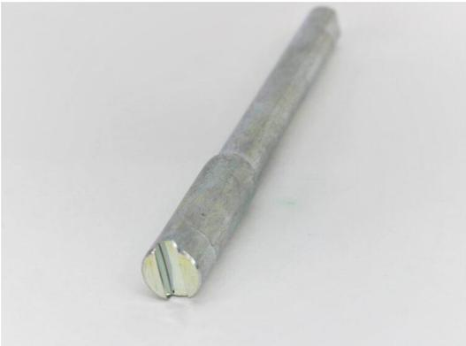
圧造によるマイナス溝+先端の小判絞り成形をした製品です。お客様のご要望で、マイナス溝深さを最大限確保する必要がありました。そのため、圧造段階ではマイナス溝形状と共にツバ部を成形し、後の工程で外周を削る工程を採用いたしました。
