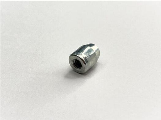
圧造加工にてツバ有で完成形の形を形成し、切削加工にてタップ加工・ツバを切削することで製造しています。また、こちらの部品が使用される製品が屋外保管の可能性を考え、いじり止め加工として頭部形状にヘキサロビュラを採用しております。
