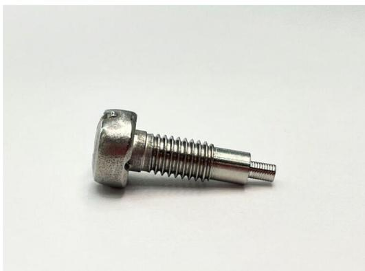
こちらのボルトは、座面下に4点のくぼみがあり、切削加工にて軸部を細くしています。先端部に切削での面粗さをわざと残すことにより、樹脂に埋め込んだ際の食いつきがよくなるよう加工された商品です。また座面下にくぼみをつけることにより、接地面にめり込むことで緩み止め効果が生じます。
