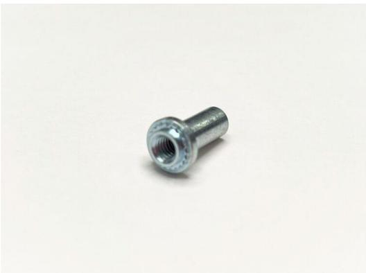
本製品は袋穴形状のクリンチングナットとなっており、圧入する対象を異品や異物が多い所に設置する際に本製品を使用することで、内部への異品混入を防ぐことができます。また、本製品は測定器や遊技機にも使用されております。
