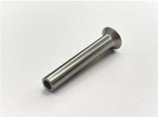
加工のポイントとしては端面の穴になりますがこちらを圧造での穴あけを行うことにより工数削減を実現し、コストダウンを実現することができました。また、ステンレスの防錆効果を高めるためにパシベート加工をご提案いたしました。
