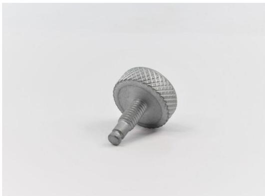
これは太陽光発電システムのパワーコンディショナーの底蓋の開閉用に採用されたネジです。蓋を開閉する際に手で回しやすくするために頭部にローレットが設けられています。また、蓋からネジが脱落しないようEリングが使用されていますが、そのEリングが嵌る溝も設けています。
