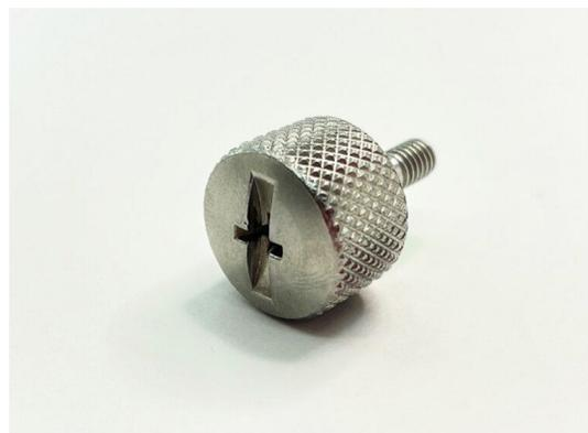
これは太陽光発電システムのパワーコンディショナーの底蓋の開閉用に採用されたネジです。頭部の体積と比較するとネジ径が極端に細く、初期設計時では全切削品が用いられておりましたが、量産時に当社の圧造と切削とのコンビネーションによりコストを1/4まで下げることを実現いたしました。
