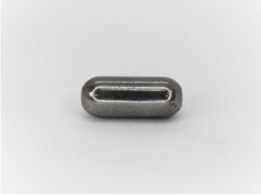
まずリベットを圧造しその後当社固有のフォームローリング技術により、1工程(1パス)で両端にR付け加工をして生産いたしました。その結果、全切削品のコストと比較して半値以下のコストダウンを実現することができました。
