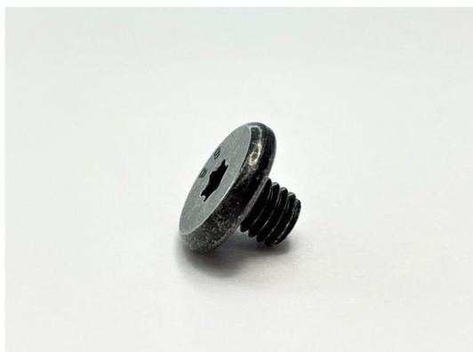
こちらの製品のポイントは、圧造での刻印と、短寸ねじならではの転造の2点です。圧造については、頭を成形する際に、同時に刻印をつけることで、2工程あったところを1工程に工程削減しました。転造においては、もみ切りを行うことなくネジ部の成形を行うことで、お客様のご要望に応えました。
