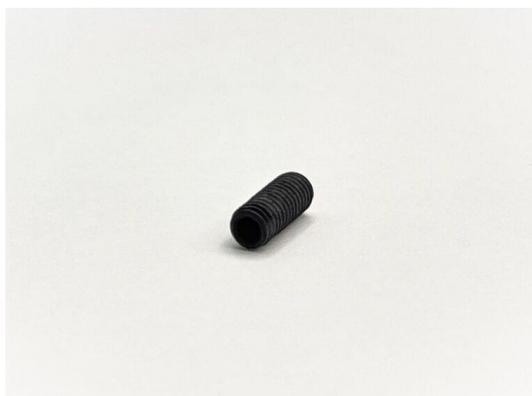
協力企業にて圧造ブランク後に、表面処理、コーティングを行い、製品を製造しています。寸法公差が厳しい製品ということもあり、SSブラックにて表面を黒色にしています。またコーティングによりねじが抜けにくくなるように加工しております。
