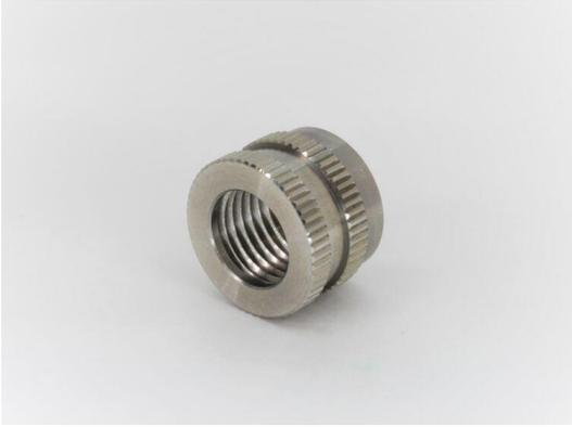
SUS304の棒材から全切削で加工して生産いたしました。こちらのインサートナットは、お客様にて樹脂金型にインサートして成形する製品のため、雌ネジタップ後の内径が非常に重要となりました。そのため当社では、仕上げ工程で内径にリーマ加工をして、精度UPをいたしました。
