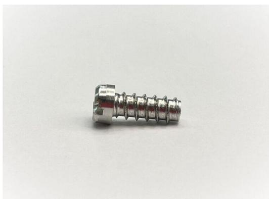
圧造完了後に熱処理を行い、硬度を高めた後に切削→転造にて加工しています。アルミ材料でありながらBタイト製品のため、雌ネジを形成しながらねじ込まれる必要があり、表面の硬さも重視されます。表面処理においては、製品外観といった部分に関してもアルミ専用のアルマイト処理を行っております。
