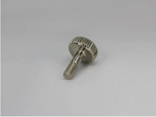
圧造工程で頭部形状を据え込み、ネジ部の絞り加工率を高く仕上げしております。その後転造工程で、頭部の平目ローレットやセルフタップねじを加工しております。今回のつまみねじは住設部品ということもあり、表面処理は外観に優れたニッケルメッキを施しています。
