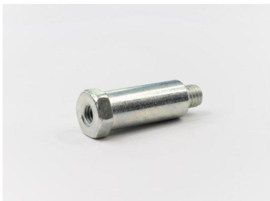
先端がM5のねじになっていて、頭部から製品中心部にかけてタップ加工にてM4の雌ネジが施されています。元々は別の部品を2つ用いて基板との間にスペースをとっていた製品ですが、部品点数を一つにまとめ一体化に成功した部品です。
