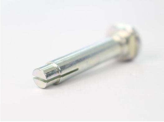
頭部形状は小判形状で、その下の段部も小判形状と“クロス小判形状”になっております。またスリ割り溝はMCによるフライス及びバリ取り加工を採用しており、専用治具を使用して位相も確実に合わせることで、多数個取りも可能にしているため、大量生産対応が可能です。
