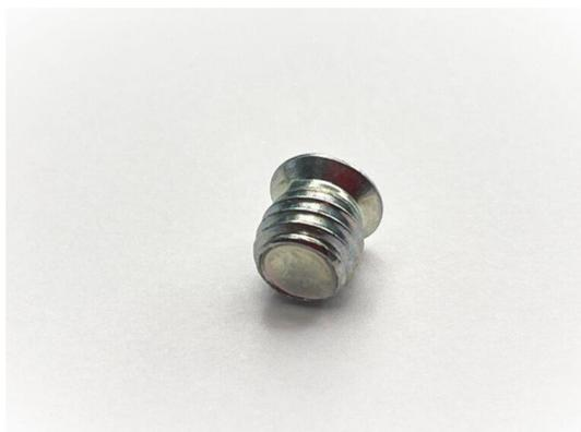
プラグねじの機能を満足させるために、首元のφ径がねじ谷径よりも細くなっております。開発時に他のネジメーカーが首元を削る構想で検討されていましたが、短寸すぎて加工することが出来ず、お客様から緊急で当社に検討依頼をいただいた案件です。
