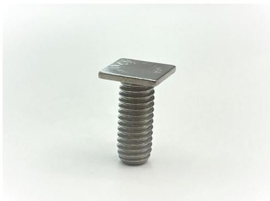
材質はSUS XM7で、頭部厚み1.0と非常に薄く、かつ頭部四角形状となっているため、圧造後にプレスにてトリミングをしております。高精度かつスピーディーに四角ボルトの生産が可能です。
